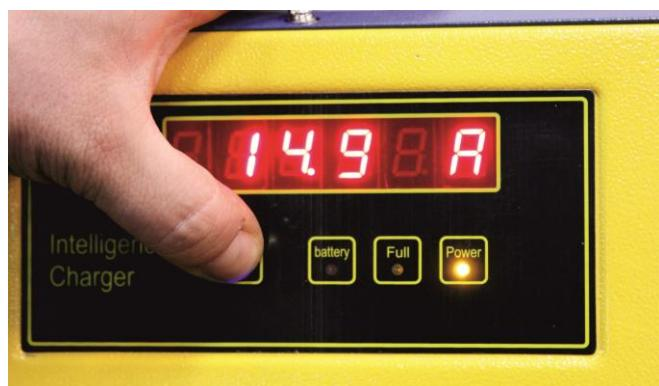
В качестве защиты от случайного нажатия кнопки режим включится только после 3-4-х секундного удержания кнопки нажатой.
